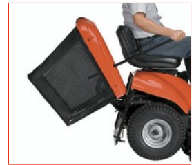
Grasfangkorbentleerung mit Teleskophebel
