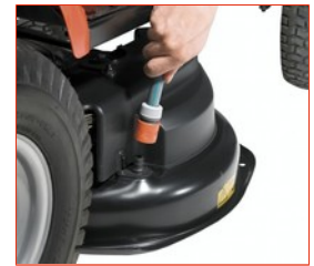
Wasseranschluß für die einfache Reinigung des Mähwerks
